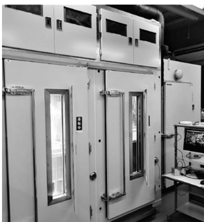
環境を高精度に再現する新型人工気象器 (2連式)
